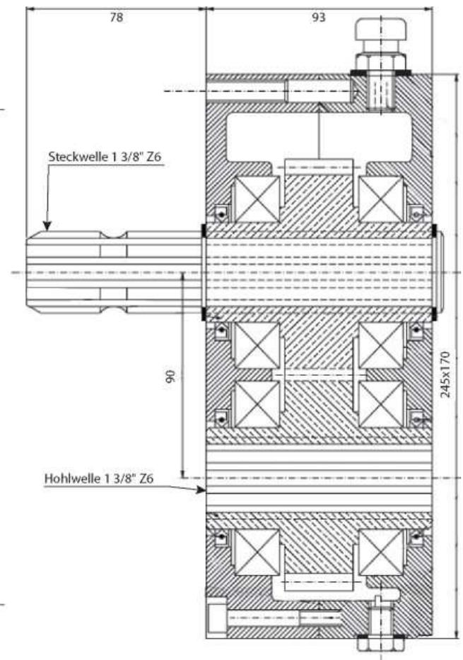
**Getriebe ungefüllt – Ölfüllmenge 0,45 Liter – Typ 85W90**
